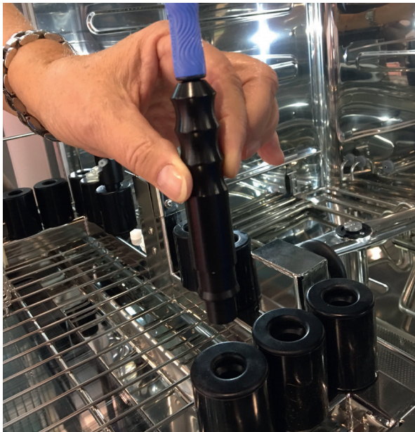
Aufnahmevorrichtung für den Cavitron Insert Adapter am Beispiel eines Gethinge Thermodesinfektors
