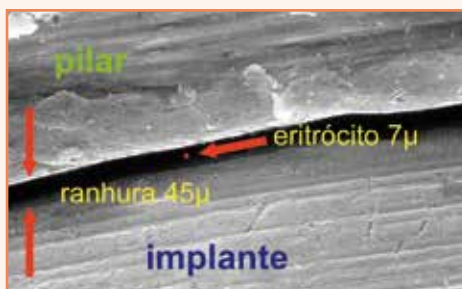
Ranhura entre o pilar e o implante
